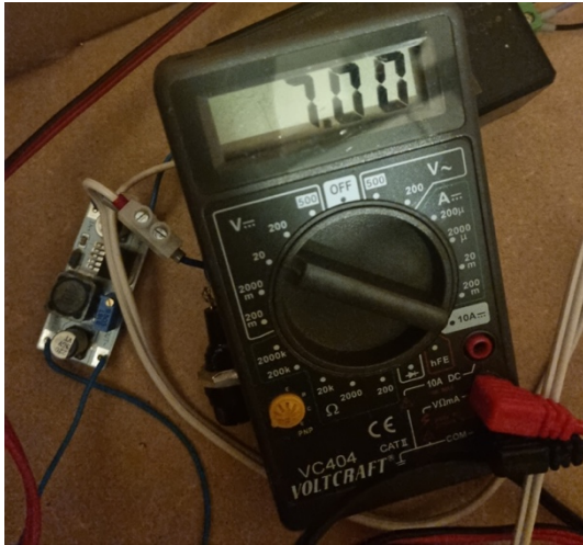
Abbildung 47: Einstellen der Ausgangsspannung, Step-Down Converter
