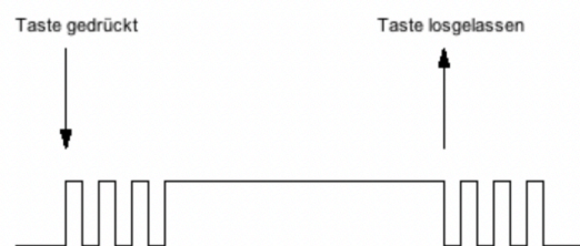
Abbildung 38: Schalterentprellung mit Veranschaulichung (Artikel zur Entprellung, 2017)
